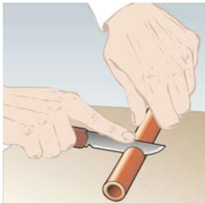
1. Corte perpendicularmente la manguera con un cuchillo afilado. Si fuera necesario use un lubricante (solución de agua/jabón al 5%) para facilitar el montaje.
