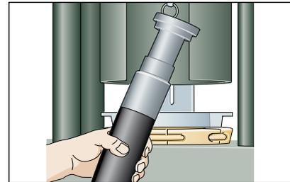
Presione el botón negro en la parte superior de la caja conmutadora para abrir las mordazas y retirar el latiguillo terminado. Usted no tiene que retirar ninguna herramienta para retirar o insertar terminales rectos. Se debe retirar la mitad frontal del anillo de mordaza partido y la parte frontal del juego de mordaza articulado para insertar y retirar los terminales de tubos curvados.
