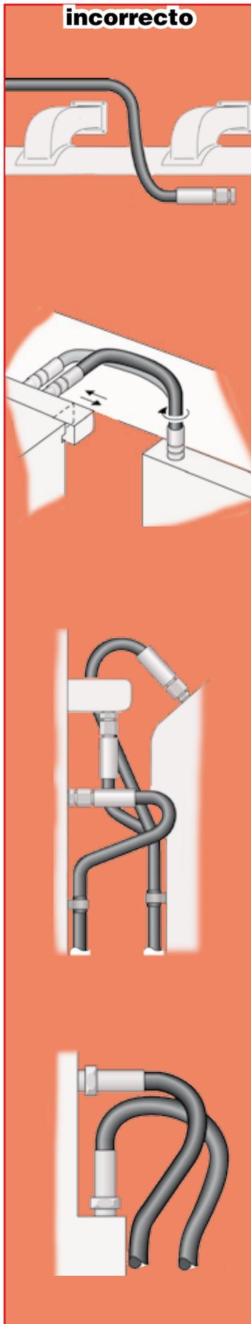
Debe existir una **fijación correcta** (sujeción/ soporte) de la manguera para realizar un trazado seguro y evitar que haga contacto con superficies que provoquen su deterioro.
